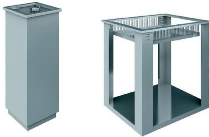
Sollevatore piatti neutro o caldo e sollevatore cestelli neutro o caldo. Realizzati in acciaio inox AISI 304. Livello variabile della pila aggiungendo o togliendole apposite molle. Regolazione del diametro dei piatti. Regolazione della temperatura da +30°C ÷ +110°C tramite termostato. Modelli per piatti Ø 200 ÷ 260 mm, per piatti Ø 260 ÷ 310 mm, per cestelli 500x500 mm o vassoi 370x530 mm.
