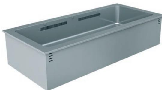
Vasca calda ventilata da incasso, realizzata in acciaio inox AISI 304. Ideale per esporre pietanze in piatti o vassoi. Regolazione della temperatura da +30°C ÷ +80°C tramite termostato. Vasca raggiata e stampata, profondità h. 215 mm. Disponibile nelle dimensioni 2-3-4-5-6 GN.
