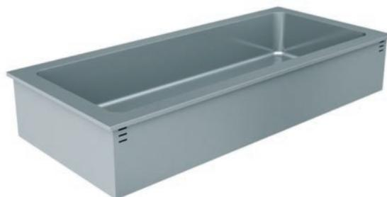
Vasca bagnomaria da incasso, realizzata in acciaio inox AISI 304. Ideale per esporre pietanze in contenitori. Regolazione della temperatura da +30°C ÷ +80°C con termostato. Mantenimento automatico del livello d'acqua. Vasca raggiata e stampata, profondità h. 215 mm. Disponibile nelle dimensioni 2-3-4-5-6 GN.
